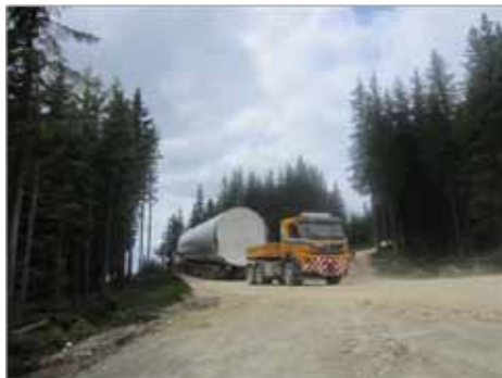
Foto 2: Transport Turmsegment eines Windrades – Quelle: Fotoarchiv Alpenverein Molln
